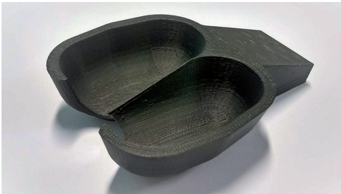
FIGURA 34. Modelo de una cuchara Pelton fabricado mediante fabricación aditiva para su posterior réplica en acero mediante fundición en arena
